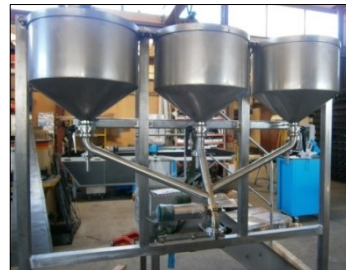
Installation de dosage de sauces (INOX 316 L)
