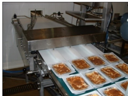
Séparateur 4 en 1 pour pesage et étiquetage unitaire
