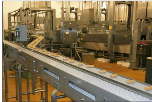
Ligne de process de produits asiatiques, haute cadence 12 000 pièces / h
