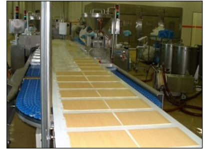
Ligne automatisée de production de lasagnes
